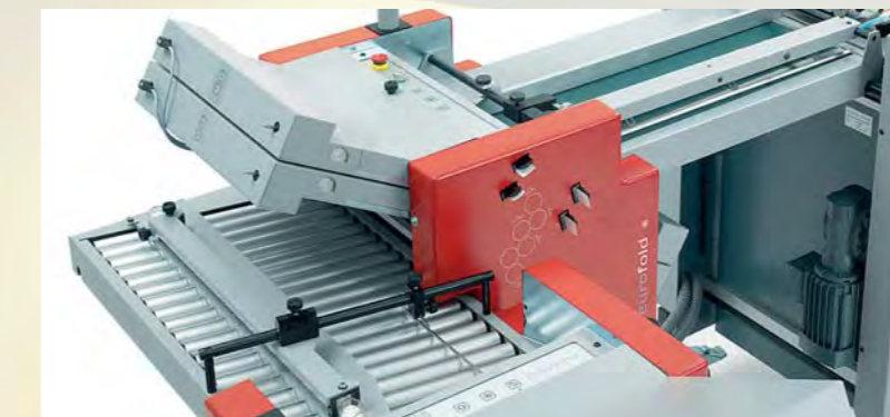
La station pli croisé. Tous les modèles Eurofold peuvent être équipés avec une station pli croisé à tout moment.
