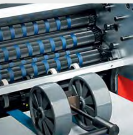
Les cylindres mixtes avec entraînement par pignons hélicoïdaux.
